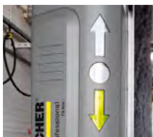
Удобство позиционирования Портал может быть оснащен светофором (опция), облегчающим водителю заезд на мойку.
