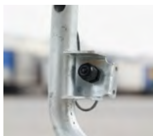
Безопасность технологического процесса Фотореле, распознающие контуры автомобиля, исключают возникновение проблем в процессе мойки.
